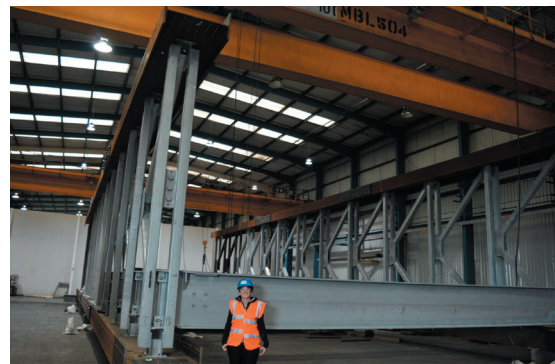
Section d'un pont MTQ 100+ m
