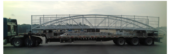
Chaque passerelle a été livrée sur une remorque à plateau et installée en une journée.
