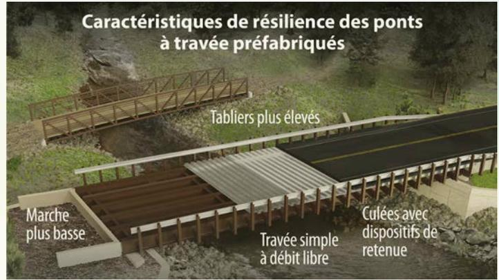
**Résistance aux changements climatiques :** caractéristiques de résilience aux conditions météo extrêmes aptes à réduire les risques d'inondation et de dommages causés par des débris en raison des changements climatiques – p. ex., travée plus large, remblai renforcé par géotextile, protection anti-affouillement, dégagement vertical accru et plus encore.
